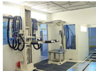
威鋁では、下塗りや仕上げ塗装の工程において、高速回転するタービンを使ったベル型静電塗装機を配置し、一般的な塗装機ではメタリック塗料の噴霧塗装の際に色ムラが生じやすいという問題を克服しています。
