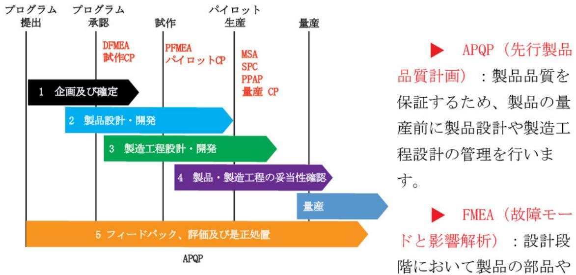
各工程の潜在的な故障モードを摘出し、起こり得る結果を解析します。
