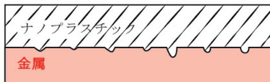
ナノモールディングテクノロジー（NMT）は、金属と樹脂をナノレベルで接合する技術で、まずT処理（特殊溶液に浸漬処理）することで金属表面に微細な凹部を形成し、それから樹脂を射出成形して金属の凹部に浸透させ、一体成形します。T処理の手順は次の通りです。
